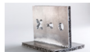
Weiterverarbeitungsmöglichkeiten: Bohren, Schweißen, Fräsen
